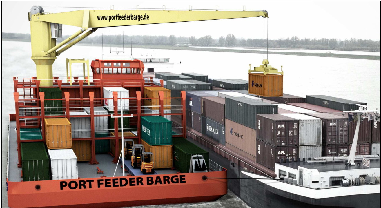
Abb. 1. Virtual Reality: Eine "Port Feeder Barge" schlägt selbständig Container auf ein im Strom liegendes Binnenschiff um
